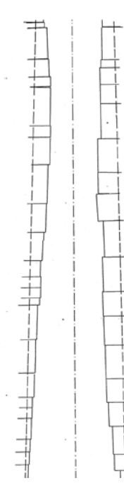
Τομή με το σχήμα της παραμόρφωσης των τοιχωμάτων του διαδρόμου.
